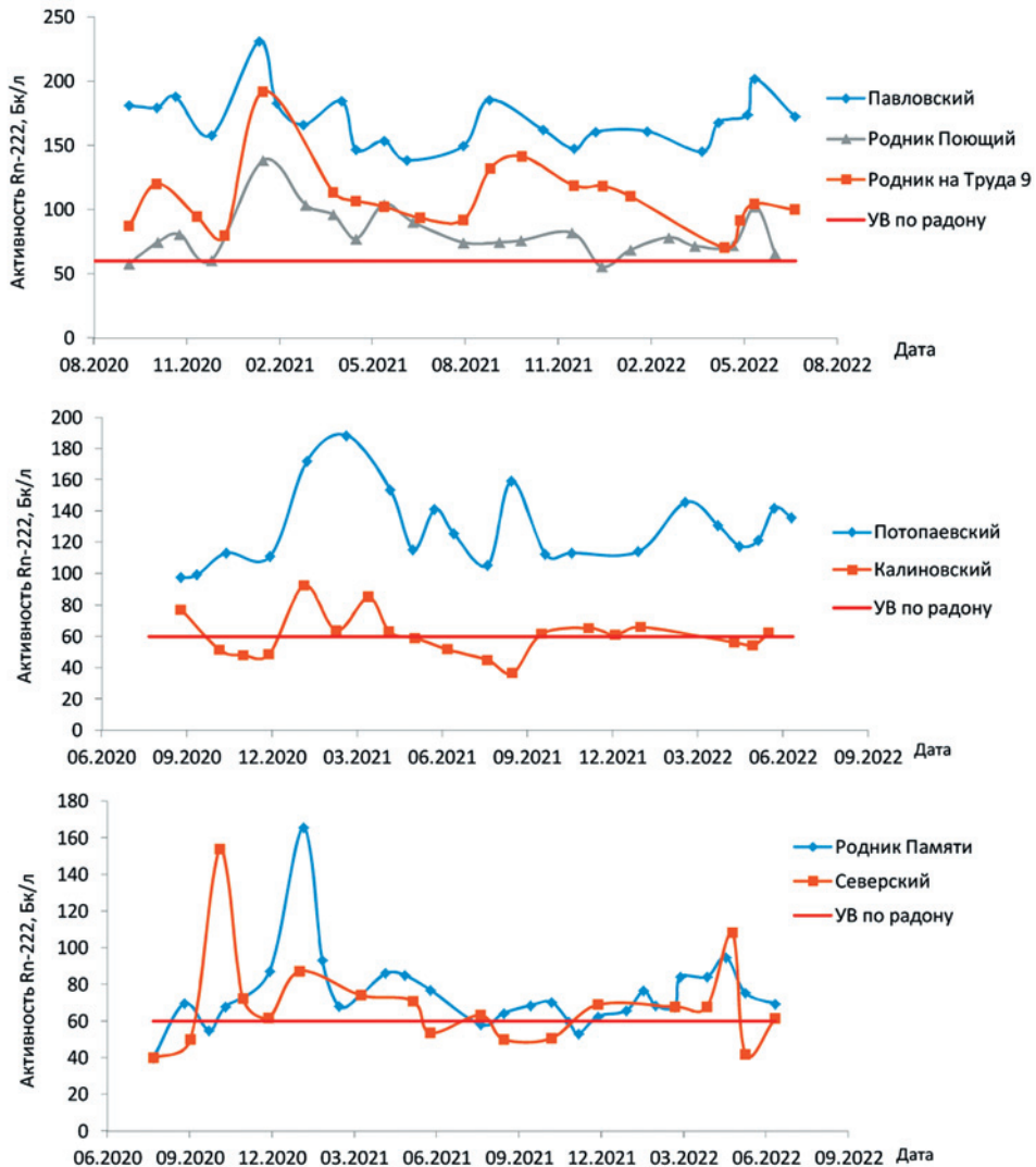
Рис. 2. Сезонные колебания удельной активности Rn-222 в родниках: УВ – уровень вмешательства по радону-222 (60 Бк/л).
